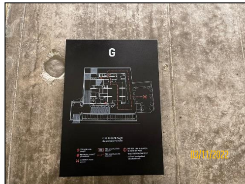
รูปที่ 2-82 แบบแปลนแสดงตำแหน่งที่ติดตั้งอุปกรณ์ ดับเพลิงต่าง ๆ ติดไว้ที่หน้าโถงลิฟต์ทุกชั้น
